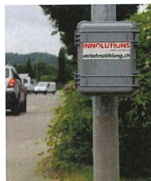
Die Abteilung Verkehr (AVK) führt auf dem gesamten Kantonsgebiet regelmässige Verkehrszählungen für die Verkehrsstatistik durch. Die Arbeiten werden von der Firma Innolutions AG, Villnachern, durchgeführt. Die Zählgeräte werden dazu an geeigneten Standorten neben der Strasse (zum Beispiel an
